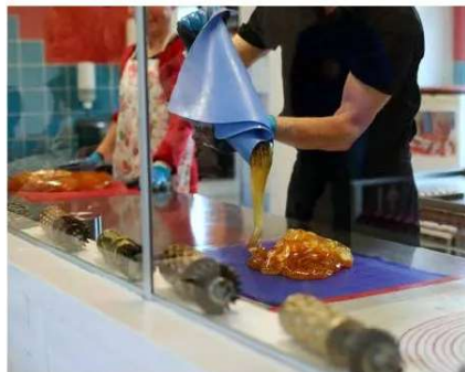
5 Sockret läggs över på en kallare yta så att massan tjocknar något.
